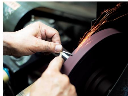
手作業で一本ずつ刃を研削する小刃付けの工程。はさみの切れ味を決める大切な作業。
