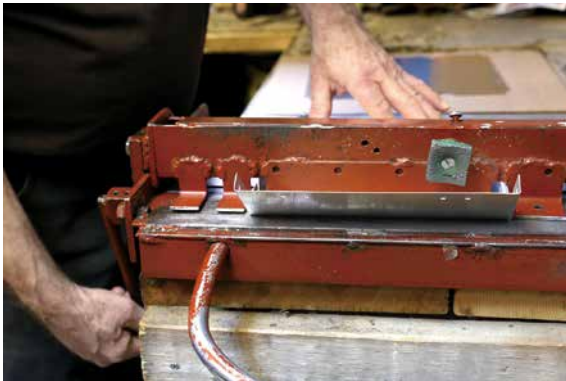
アルミの板を一枚ずつ曲げて、パーツをつくります。 Aluminium plates are individually bent to form each component.
