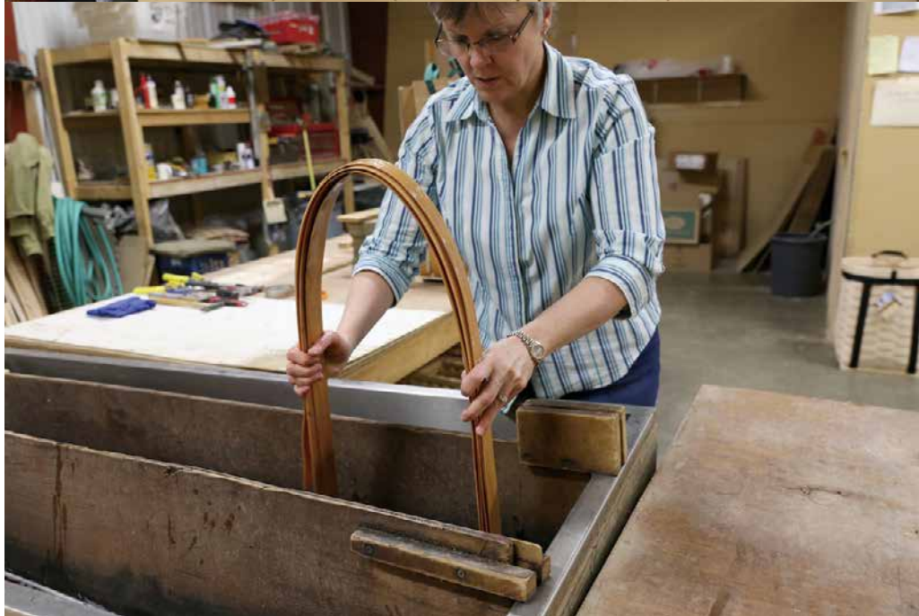
細長くカットしたメープルの板を水に浸けやわらかくし、土台を固定して型枠をはめ込み込みます。 乾燥すると驚くほど軽くて頑丈な背負いかごとなります。
