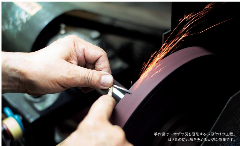
手作業で一本ずつ刃を研削する小刃付けの工程。
