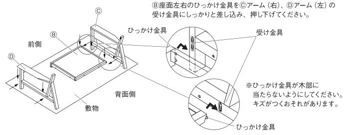
■ をひっかけ金具がはずれないように、座面を手で押さえながら前側に倒し、③、⑤、⑥を取り付けます。
