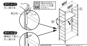
背面のA®高さ調整金具・左/右のフックを、帆立の帆立柱に引っ掛け
