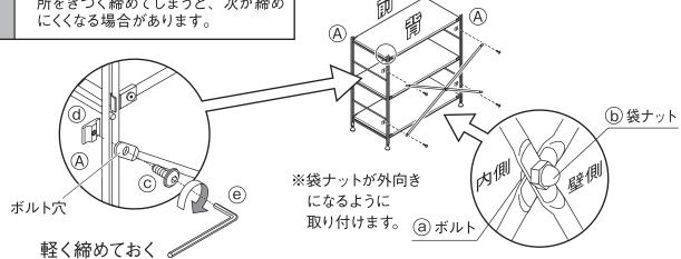
**8** 最後に、手順 3 ~ 5 で軽く締めた®棚板のフック用ボルトと、手順 6 ~ 7 で軽く締めたクロスバーの ⓐ ⓒ ボルトを、 ⊕ 六角レンチできつくなるまで締めてしっかり固定します。 (全部で 17 箇所)
