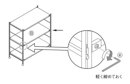
⑥クロスバーの中心を重ねて⑥袋ナット(クロスバー中心用)と③ボルト(クロスバー中心用)を軽く締めてください。
