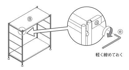
5 手順 3 と同じ要領で残りすべての B 棚板を取り付けてください。 ※収納する物の高さに応じて、取り付け位置を決めてください。
