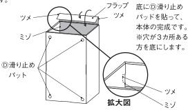
B引出しを組みます。 側面を起こし、フラップを巻き込みながら ツメをミゾに差し固定します。
