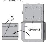
A本体を起こし、底面を組みます。 連結用部材をミシン目に沿って切り取ります。 ※2つ以上並べてご利用の場合、 連結用部材を使用します。
