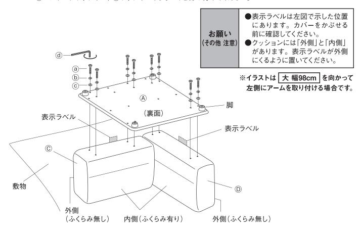
**3** ② を下図のように立てて、®座クッションを置き、@ベース裏面の通し穴を確認し、®座クッションを ④六角レンチを用いて、@ボルト、⑥スプリングワッシャー、⑥ワッシャーでしっかり締め付けてください。 ※®座クッションを@ベースにしっかりと押し付けながら@ボルトを締め付けてください。
