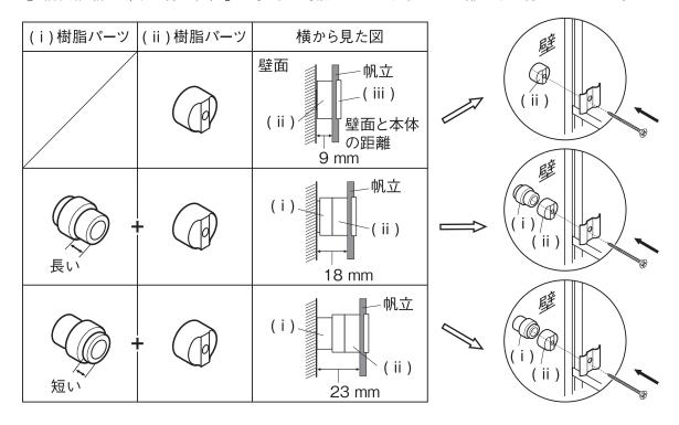
壁の材質を確認の上、 🛕 ~ 🖸 いずれかの方法で壁に取り付けてください。
