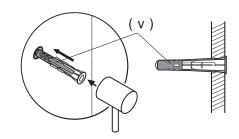
③ (i)、(ii) と (iii) で帆立をはさみ込むようにし 差し込んだ (v) に (iv) で壁に取り付けます。
