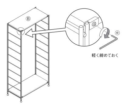
残り全てのB棚板を手順 3 と 同じ要領で取り付けてください。 ※収納する物の高さに応じて、 取り付け位置を決めてください。
