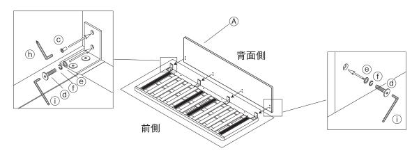
**3 2** を取り付けた後、B座面の前側から、穴にしを入れ、②、 ①、 ②を ② 音板の背面側から取り付けます。 ※② が取り付けられるように、 ② の穴の向きは、 ① を使って調整してください。
