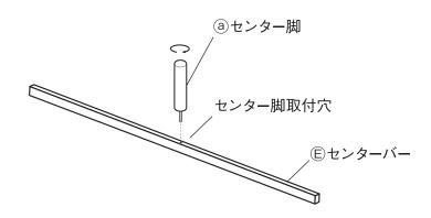
Aヘッドボード、Bフットボードに取り付けてある bセンターバー受け金具の上に、 Eセンターバーを@センター脚を下にした状態で置きます。
