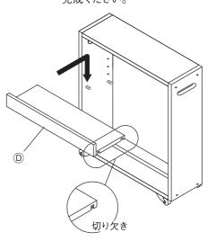
A側板に取り付けた@の上に ◎棚板の切り欠きがはまるように 取り付けてください。
