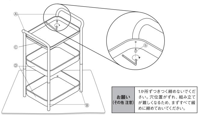
■ B支柱の先端に、ⓒ、ⓓ、◉のボルトを差し込み、①でしっかりと固定します。
