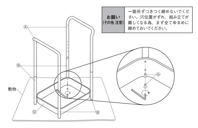
3 ② と同様に、®トレー(深型)を、 ■ で組み立てた@ハンドルの 中段用ガイド穴 の任意の位置に合わせ、®を使い、®で内側から軽く締め付けます。(合計 8 箇所)( ■ できつく締めます。)
