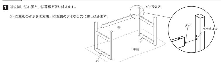
② D幕板のダボとB左脚、C右脚のダボ受け穴を接合した後、 ⑥を⑥に差し込み、お手持ちのマイナスドライバーを **⑤**の溝に合わせ、**⑥**のボルト穴が側面に向くように 調整してください。
