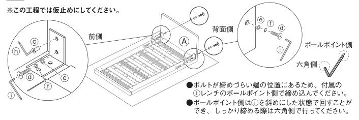
**2**を取り付けた後、B座面の前側から、穴に⑤を入れて⑥、①を通した②を⑥背板の背面側から①で取り付けます。※②が取り付けられるように、⑥の穴の向きは、⑥を使って調整してください。
