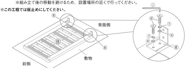
**1** の⑧の穴と④背板の穴の位置を合わせて、手で押さえながら、ⓒを向で、⑥、①を通した@を、④背板に取り付けます。⑥を取り付ける際、⑥を向で押さえてください。
