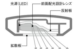
LEDは点光源のため光源の数だけ影(多重影)が発生させますが、特殊構造のセードがLED12灯の光を面光源に変換、多重影を軽減します。また同時にまぶしさも和らげます。
