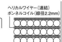
ツヅミ型のコイルを連結させ、「面」全体で体圧をしっかり支える構造です。現在、最も普及し信頼性と実績のある、弾力性にすぐれたボンネルコイルスプリングを使用しています。
