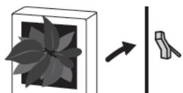
石膏ボードの壁面に壁掛けピンを取り付けて、バフカルケース裏面の壁掛け穴にピンが引っかかるように設置してください。
