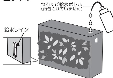
必ずパフカルが装着されている状態で給水してください。給水口から、水位が水位確認窓の給水ラインにくるまで給水してください。
