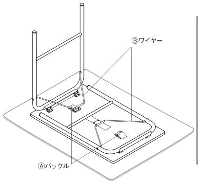
お願い (その他) 注意 ワイヤーをバックルに装着する際、きつく感じられる場合は、下図のように脚部を矢印の方向(外側)に軽く押しながらワイヤーを押し込み装着してください。金具類は、横揺れを防ぐため、取り付けの設定をきつめにしてあります。
