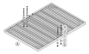
**3** で組み立てた (A) スチールフレームをワイヤー面が下側になるように裏返しにして、両手で木製脚 / スチール 脚 (別売り) を支えながら脚取り付け穴に垂直にまっすぐ入るよう回して取り付けてください。 ※木製脚 / スチール脚は別売りです。
