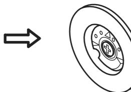
※転倒防止補助具を付け替える際は、強度が低下しますので同じ位置にネジを取付けないでください。
