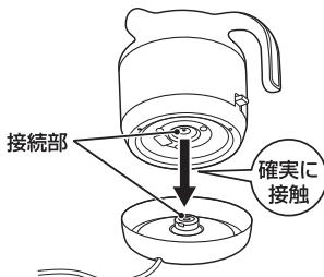
接続部を確実に接触させないと、電源スイッチを「ON」にしても通電しません。
