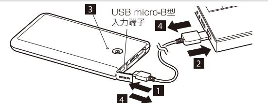
1 端子カバーをはずし、付属のmicroUSBケーブルのUSB micro-B型プラグを、本製品のUSB micro-B型入力端子に差し込みます。
