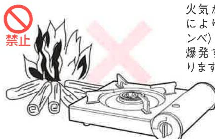
火気からの輻射熱により、容器（ボンベ）が過熱して爆発する恐れがあります。
