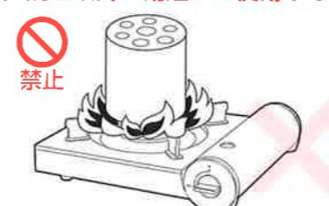
輻射熱により、熱がこもり、容器（ボンベ）が過熱して爆発する恐れがあります。
