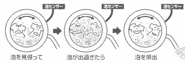
洗い中に出る泡を泡センサーでチェックし、多量に発生したら排出し、泡の出すぎをふせぎます。
