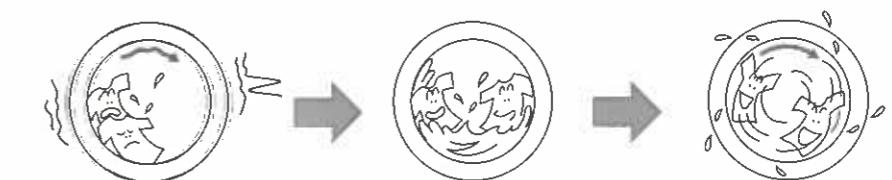
片寄りを検知すると脱水が止まり、水を加えて片寄りを修正する。その後脱水が再開します。
