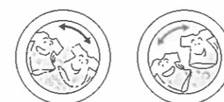
泡を検知すると、脱水の前に泡を水に溶かすために、ゆらゆらすすぎを行います。
