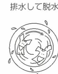
ヒーターを入れながら脱水するプリヒート脱水（洗濯乾燥時）を行います。
