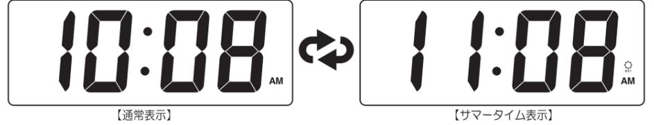
※サマータイム実施期間中に初めてご使用になる場合、また電池交換をしたときには時刻を合わせる際には、最初にサマータイム表示設定を行い、DST(サマータイム)マーク(☼)を点灯させてから日付、時刻を合わせてください。
