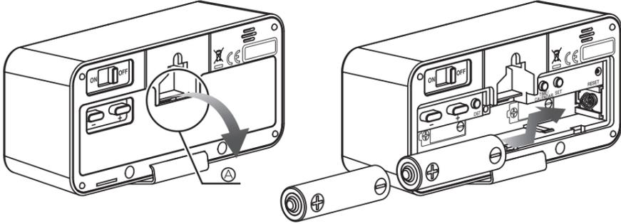
②電池ホルダーに刻印されている電池マーク(☐)の向きに合わせ、(+)(-)の向きをまちがえないように注意し、1個目の電池はまず左側に入れてから右側へずらしてください。その後、2個目の電池を入れてください。電池を入れると「ビビビッ」と電子音が4回鳴ります。
