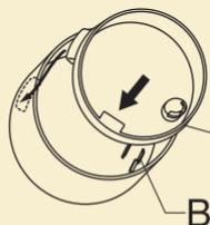
カバーの出口と内部カバーの突起A,Bを合わせます。
