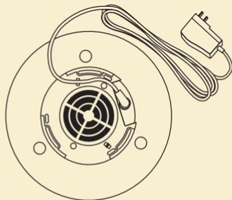
・付属のACアダプターを、本体底面のDCジャックに接続してください。ACアダプターのコードを左右どちらかのケーブルガイドに通し、安定した平らな場所に設置して下さい。
