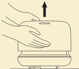
※超音波振動板が破損し、故障や水もれの原因になる為、水タンク内部の超音波振動板には、直接指で触れないでください。
