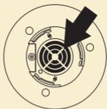
・底面の吸気口フィルター部分に髪の毛やホコリなどが付着していないか確認してください。
