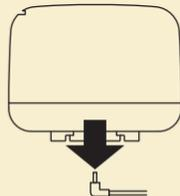
・ケーブルガイドからACアダプターコードを外した後、ACアダプターのプラグをDCジャックから取り外してください。
