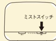
②本体のミストスイッチを押すと、ミストの運転時間を選択できます。(4段階)
