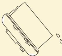
③本体を左右に軽くゆすって、底部の排水口から水を出し、本体をよく乾燥させます。
