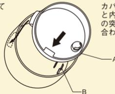
カバーの出口と内部カバーの突起A、Bを合わせます。
