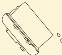
③本体を左右に軽くゆすって、底面の排水口から水を出し、本体をよく乾燥させます。
