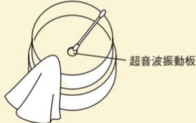
⑤お手入れ後、水タンク内に水道水を入れて30分タイマーで運転後、排水した後、乾拭きして、よく乾燥させてください。
