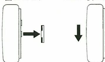
壁掛プレートの引っ掛け部に合せて、本機裏面の溝を差し込みます。
