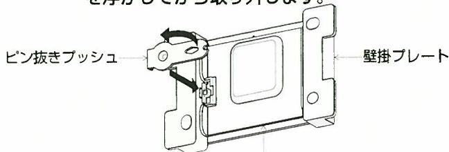
石膏ボード用取り付けピンカバー
