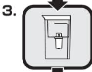
カートリッジをタンク底面の穴に差し込み、カートリッジを取り付けたタンクを本体容器にセットします。
