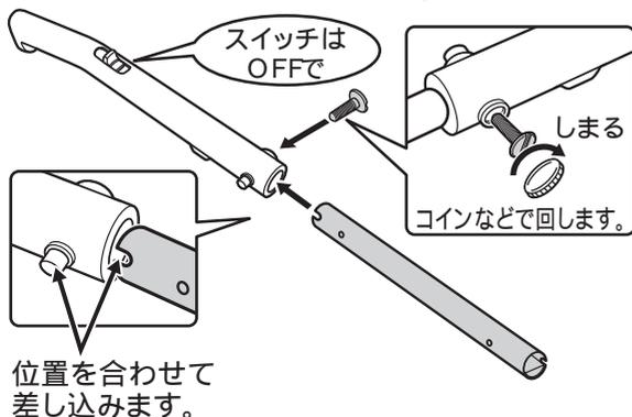
2 .1で組み立てたパイプを本体上部の穴に差し込み、ボルトで固定します。
