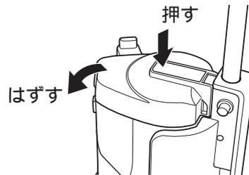
2. 本体のモーター保護窓の上にあるプレフィルターを取りはずします。
