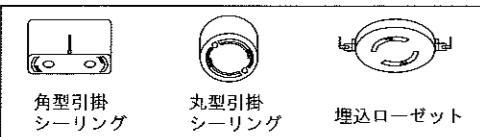
以下のような場合は、取付けができません。電気工事士の資格を持った電気工事店に依頼し、左記いずれかを取付けの上ご使用ください。
