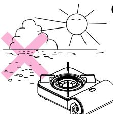
●夏の砂浜、砂利、アスファルトなど日光によって容器(ボンベ)が過熱するような場所では使用しないでください。
