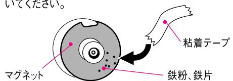
容器(ボンベ)装着時にマグネットに付着物がないか確認してください。
