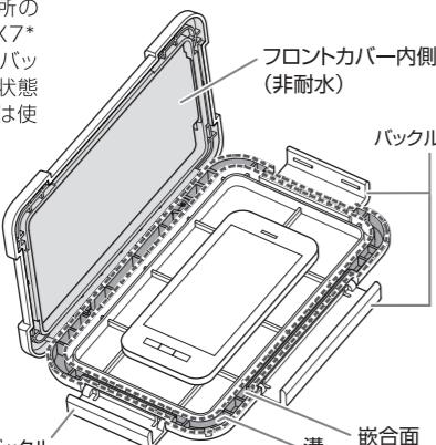
\* JIS/IEC保護等級。IPX7相当とは、常温の水道水で、かつ静水の水深1mのところに沈め、約30分間放置したあとに取り出しても有害な影響のないものです。
