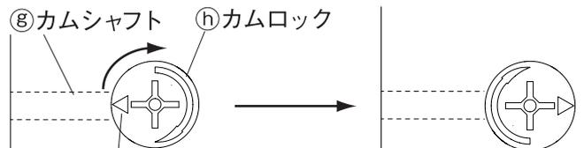
※三角印をカムシャフトの方向に合わせて差し込みます。
