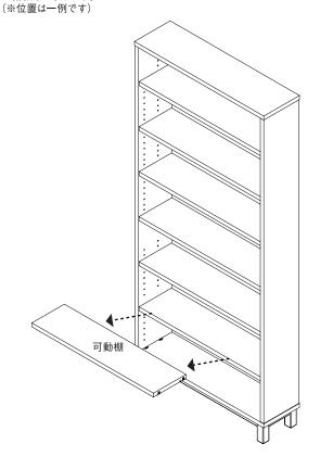
**2** 棚板ストッパーを可動棚裏の切り欠きに合わせて差し込みます。 水平に滑らせてお好みの位置に調整してください。
