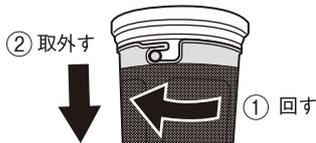
3. 布フィルターからスポンジフィルターを取外します。
