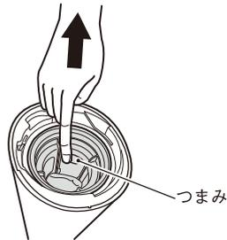
2. メッシュフィルターを矢印の方向に回してロックを外し、布フィルターから取外します。
