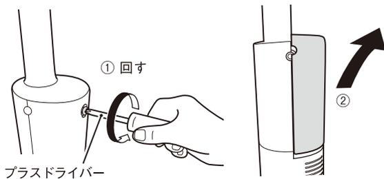
3. リチウムイオン電池パックを取外し、新しいリチウムイオン電池パックを取付けます。
