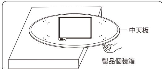
2. 付属の脚取付用ナットを中天板の穴に合わせ差し
