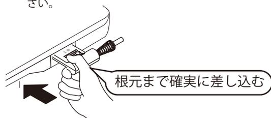
※器具用プラグを逆に差し込んでしまったり、斜めになった状態で差し込んでしまいますと、器具用プラグ、器具用プラグ受けが破損、変形する恐れがあります。
