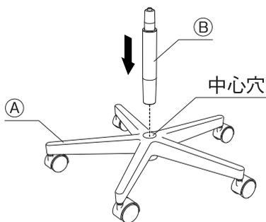
**2** ①で組み立てた脚部と③シートを取り付けます。座受金具中央の穴に②ガスシリンダーの先端を確実に差し込んでください。
