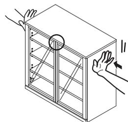
① 作業は2人で行います。A本体を左右に少しずつ傾けながら、扉のずれがなくなる位置を探してください。
