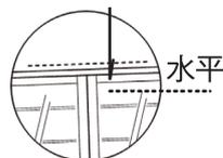
② 扉のずれがない位置で、以下の手順で付属のCフェルトを底面に差し込み調整してください。
