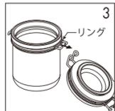
3. 取下环状配件,主体側の铁丝即可拆卸。
