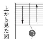
■ 直線階段 床・階段から天井の高さまでが一定して250cm以上必要です。
