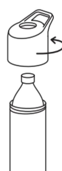
②カバーを矢印の方向へ回して、しっかりと取り付けます。
