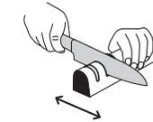
精磨 (STEP2): 精磨用砂轮
