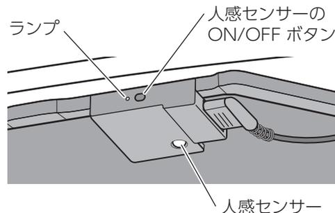
人感センサーをONにすると、人の動きを約15分感知しない場合に、自動的にヒーターの運転を停止します。(スタンバイモード)
