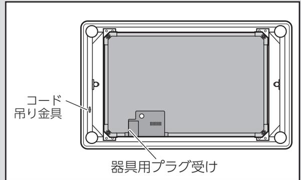
器具用プラグ受けの向きが、コード吊り金具の方向になるようにしてください。
