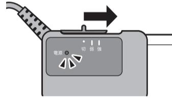
電源がONになり、電源ランプが点灯します。使い始めのときは、電源／温度調節つまみを「強」に合わせると、本体がより早く温かくなります。
