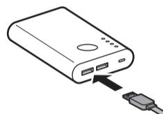
USBプラグを差し込むとスイッチが赤に点灯し、「最強」モードの温度で動作を開始します。
