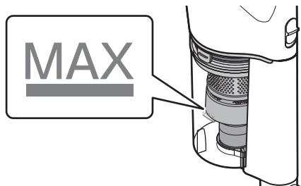
ごみを捨てずに運転を続けると、フィルターにごみが付着し、吸引力が低下したり、モーターが故障することがあります。掃除のたびにごみを捨てることをお勧めします。
