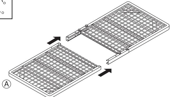
② ① - ③同様ⒶスチールフレームとⒷC型連結金具を下図のようにⓐ、ⓑ、ⓒ、ⓓを使用し取り付けます。
